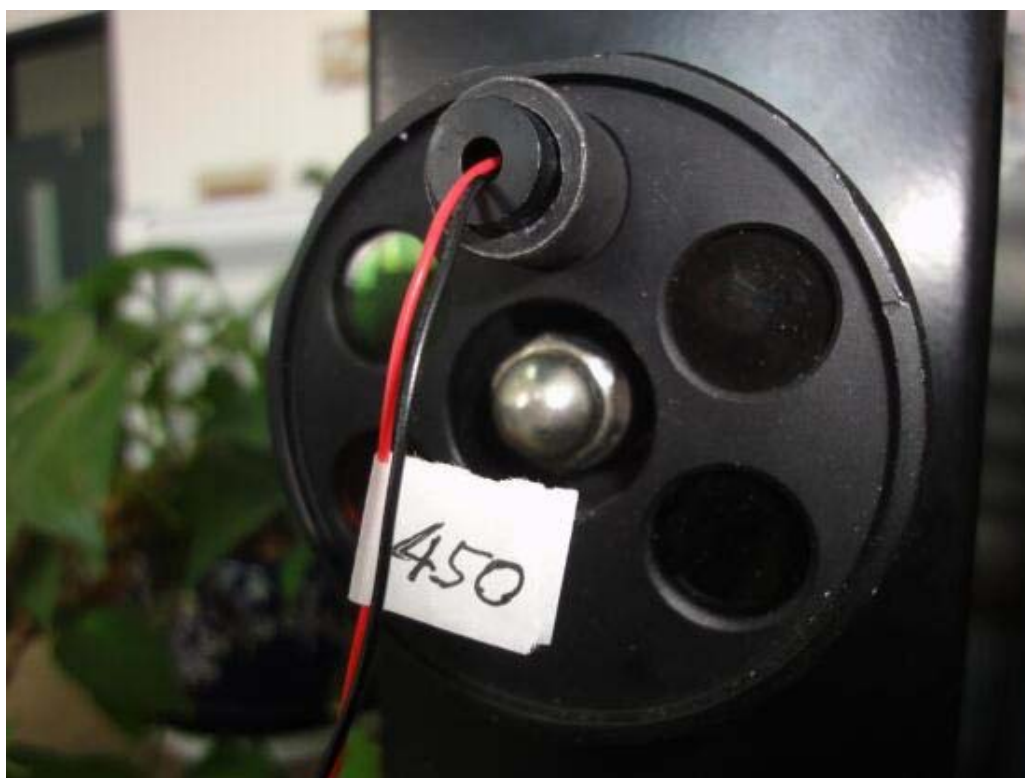
图 6 是用小型 450nm 半导体激光器插入套管测量普朗克常数实验的实物图
