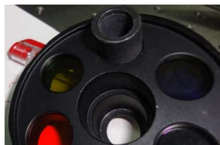
图 4 激光器套管安装在原滤色片圆盘上
