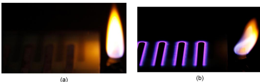
图 4 离子体激励器放电前 (a) 和放电后 (b) 的放电图像及对酒精灯火焰的扰动
