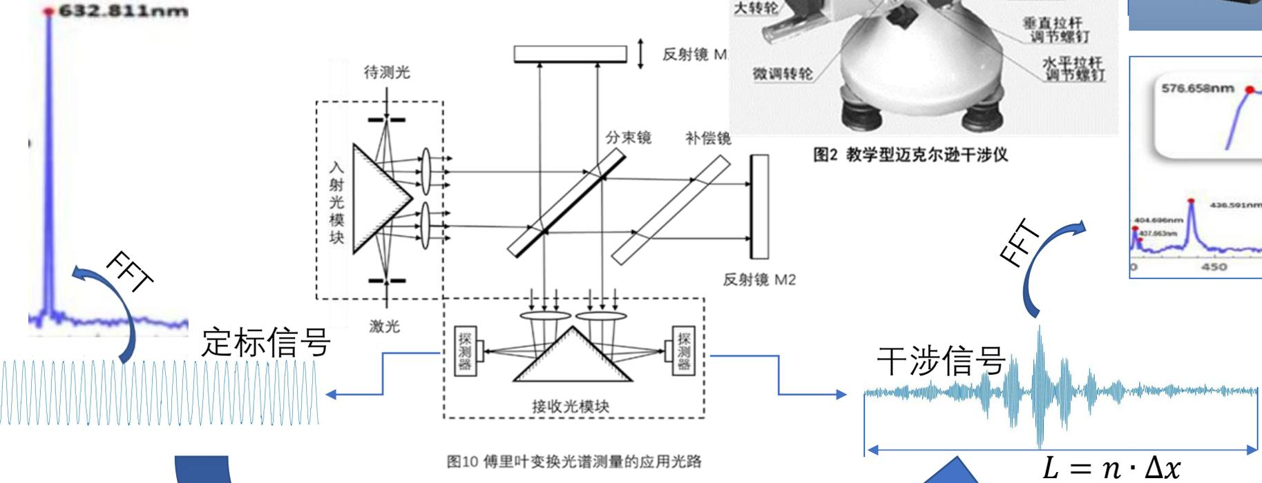
图10 傅里叶变换光谱测量的应用光路
