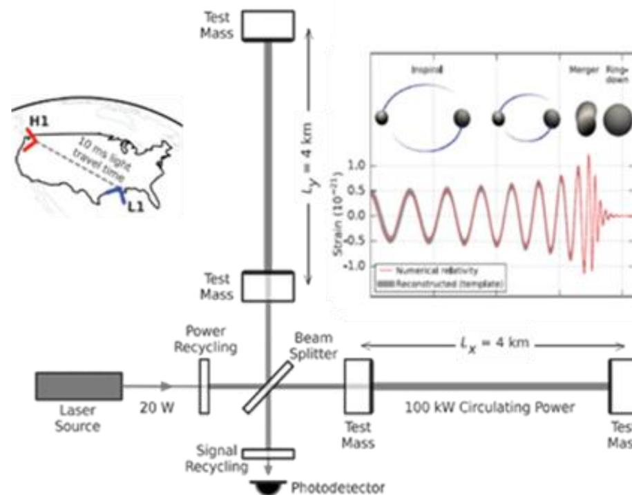
图8 LIGO 迈克尔逊干涉仪实验装置
