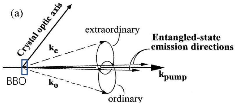
图 2: type-II SPDC 产生纠缠光子对过程示意图
