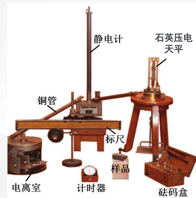
法国巴黎居里博物馆 放射性测量实验装置
