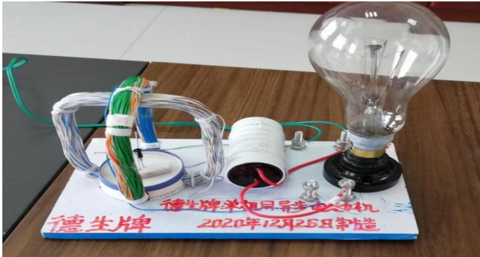
4、这是单相交流电动机原理与制作的电路图，图中的电灯泡和电容器分别与两组线圈串联，承担着高电压，起保护作用。电容器有双重作用，既能承担高压，又能让电流移相，让电流超前，电流的磁场超前。图中开关实线位置为正转，虚像位置就是反转。
