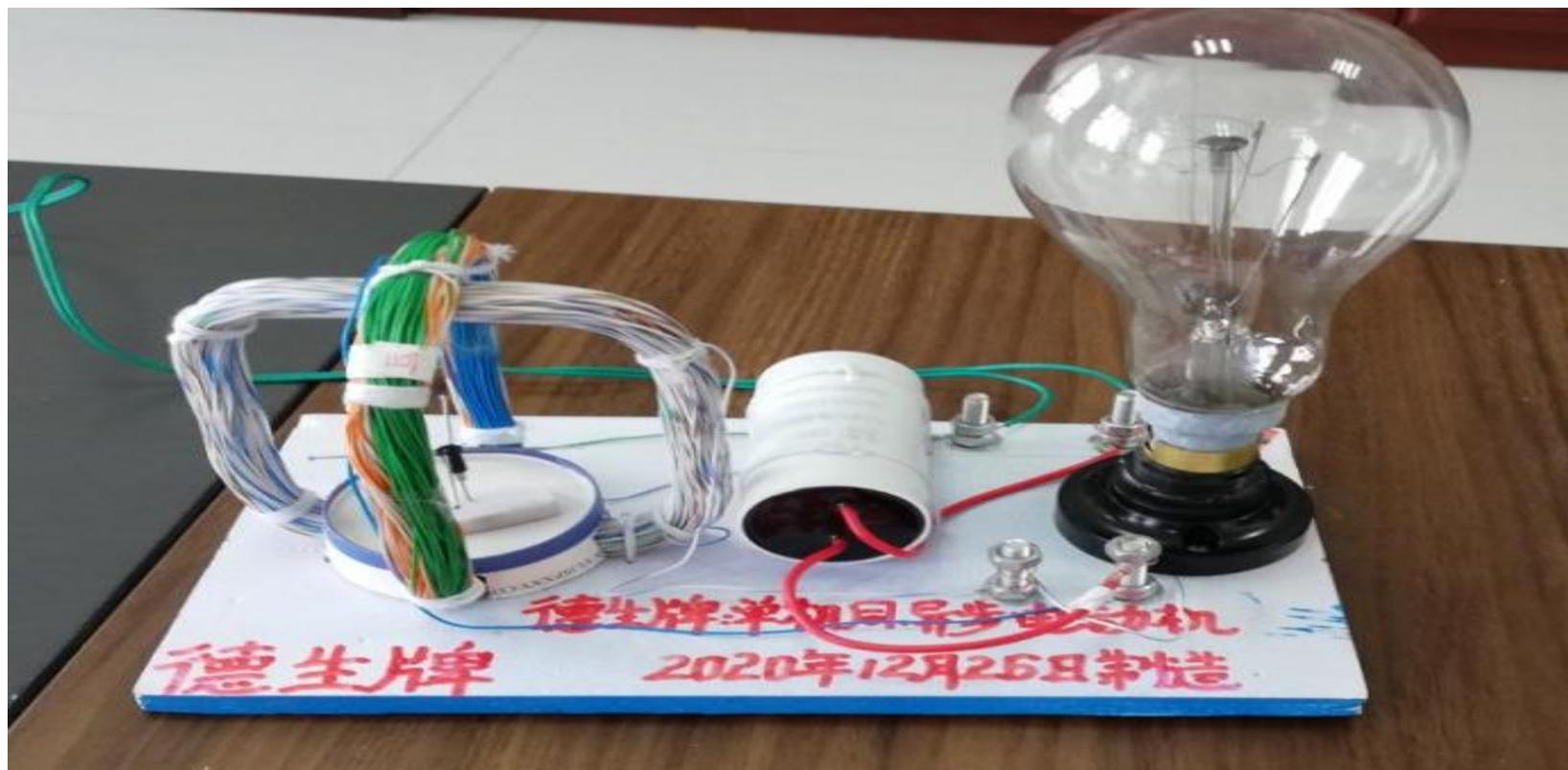
3/该电机制作十分简单,电容器和灯泡在电路中起着分压作用、（电容器起着双重作用,既分担电压又对电流进行移相）。两组线圈用单根电脑网线各绕120匝左右即可。
