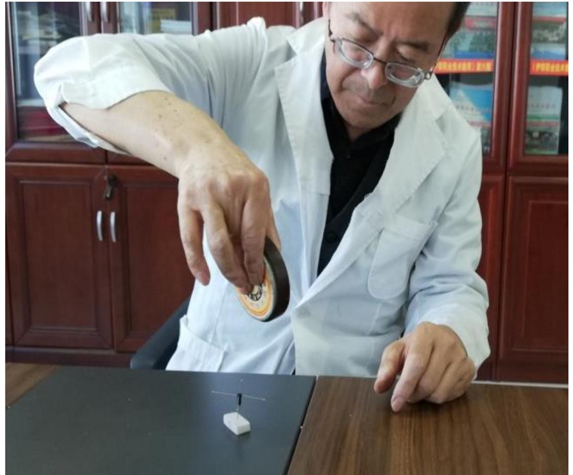
这是我制造的单相电机。1/当磁铁围着绕组转动时，转子跟着磁铁进行旋转，也就是跟着旋转磁场旋转。当接通电源时，转子会自然转动，说明，这两个绕组在空间产生了旋转磁场，这个旋转磁场，使电流产生的微观的、抽象的旋转磁场和直观的旋转磁场效果一样。
