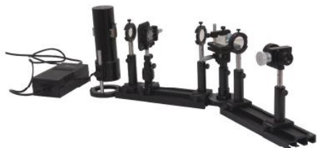
色散棱镜分光实验
