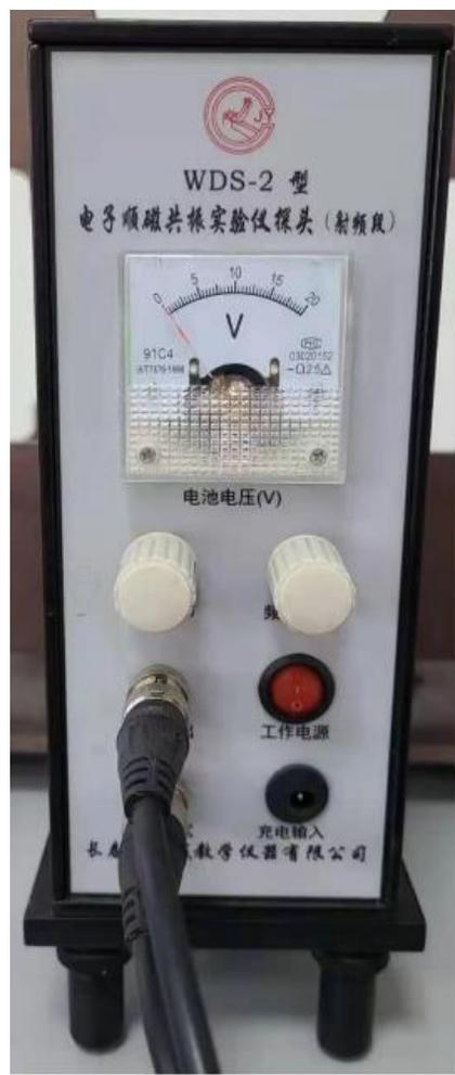
电子顺磁共振实验仪探头
