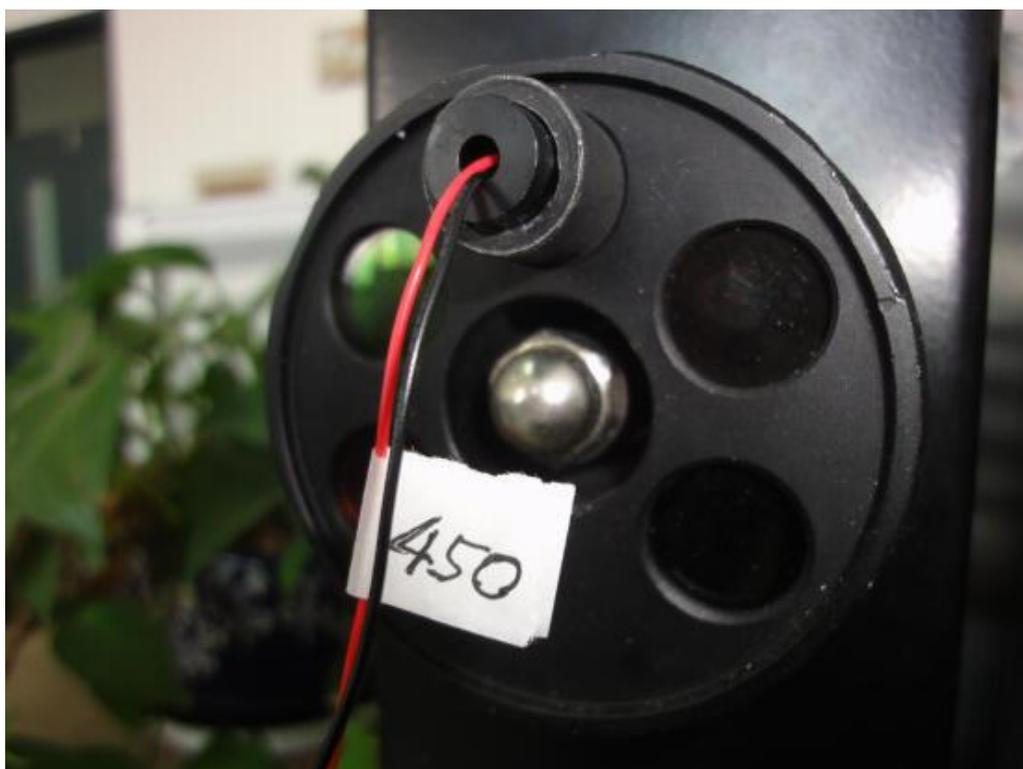
本项目研制的 普朗克常数测量实验中，半导体激光器安装在光电管进光口
