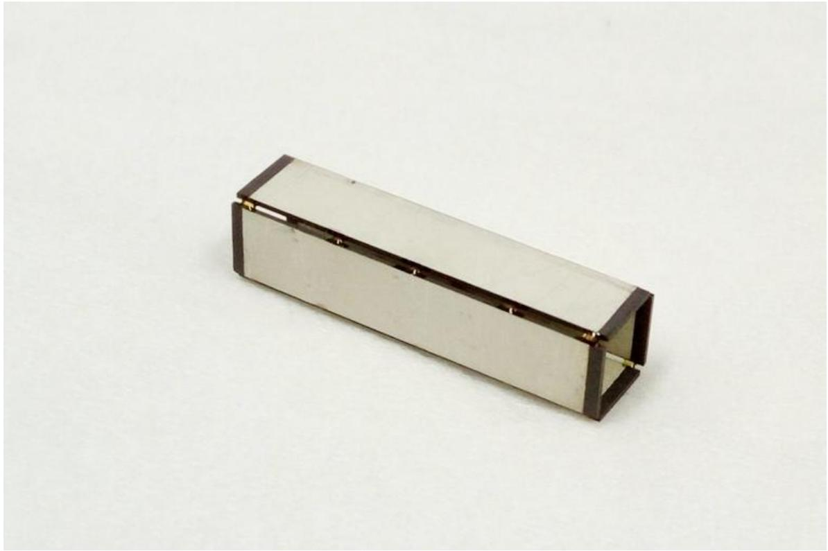
图 4. 自制方形压电管
