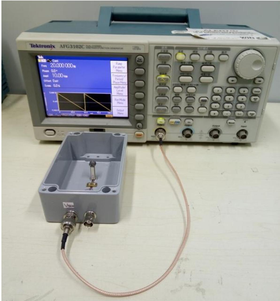
图 1. 原子操纵器式压电效应验证仪的测试图
