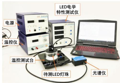
图 1 实验装置实物图
