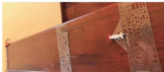
图5 改进方案所用器材及测试光路
