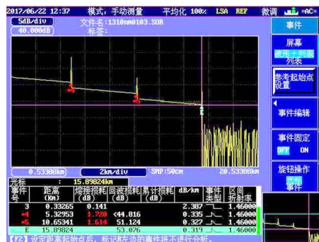
图 9 分布式光纤压力传感器系统 OTDR 原始状态
